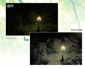
画像鮮明化フィルターシステムによる画像鮮明化
